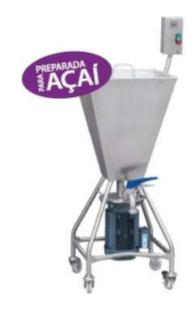
A extração do produto triturado é feita por uma tubulação, fabricada em aço inox 304, na parte inferior, de 1.½" polegada, com registro sanitário e conexões com rosca.
