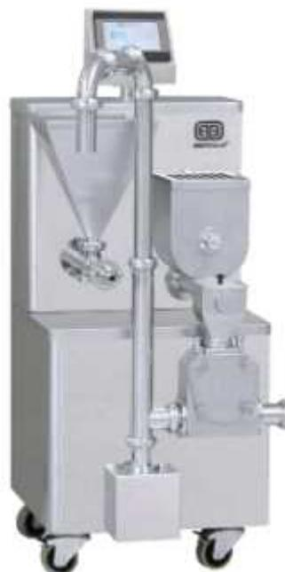
Mecanismo, tubulações e conexões, fabricados em aço inox 304, com padrão sanitário, polimento mecânico com rugosidade máxima de 0,5 µm.
