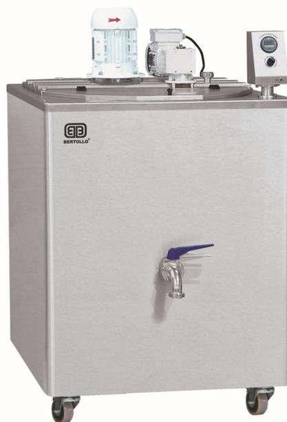
Sistema de refrigeração com compressor hermético de 4,0 cv, gás refrigerante R-22, condensação a água, condensador tipo *Shell and Tube* (fabricação Bertollo).
