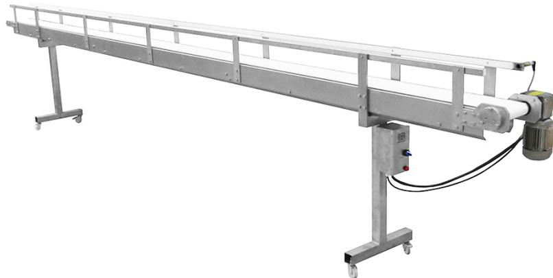
Estrutura e revestimentos construídos em aço inox 304. Rodízios giratórios de 2 polegadas, com freio. Esteira em lona de PVC atóxico.
